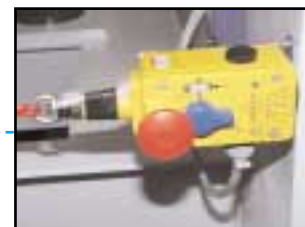
Fune più interruttore di sicurezza Perimeter E-stop System Sicherheits-Reißleine mit schalter
